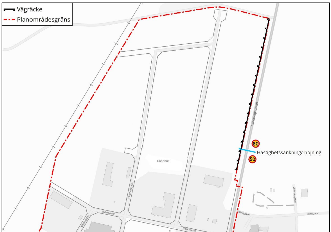
Ungefärlig placering av nytt vägräcke, cirka 340 meter
