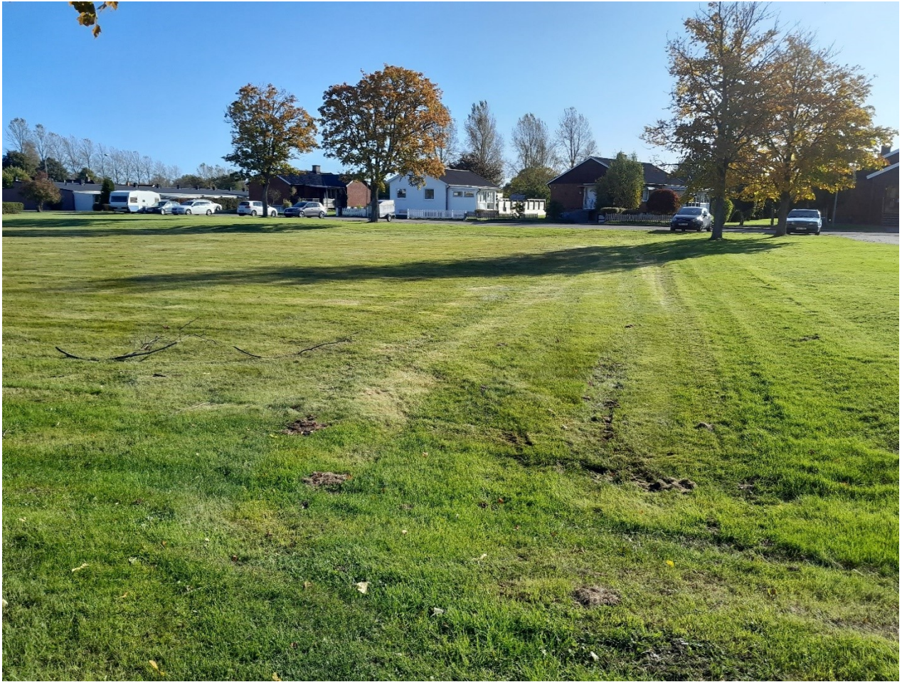
Grönområdet Emmas Hage är en fördjupning som samlar och infiltrerar dagvatten.
